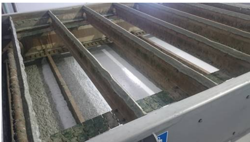
Slika.6. – Spremnik mulja u punionici Jamničke kiselice, Pisarovina. (izvor: Jamnica, vlastita fotografija)
