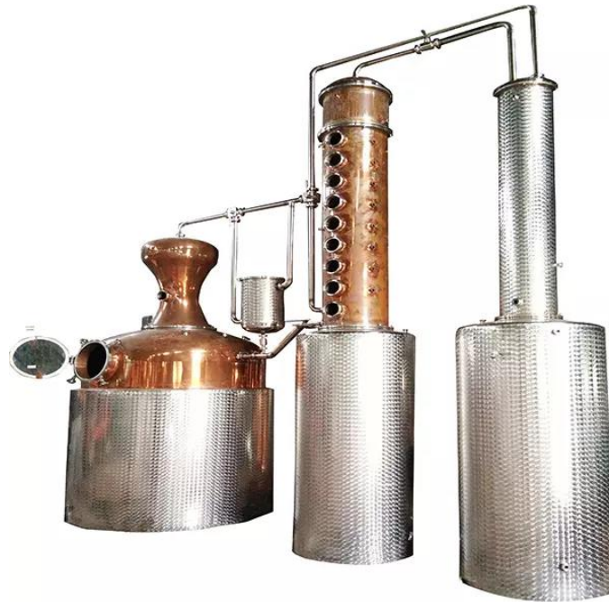
Slika 4. Kotao za destilaciju džina
