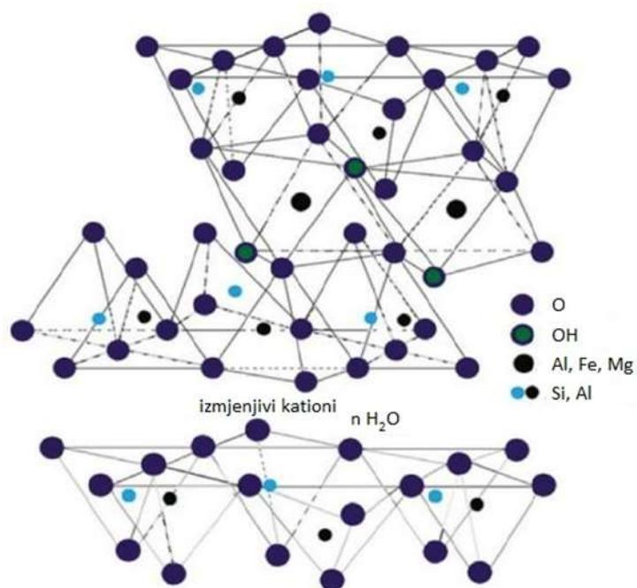
**Slika 1.** Prikaz strukture montmorilonita (Ismadji i sur., 2015)
