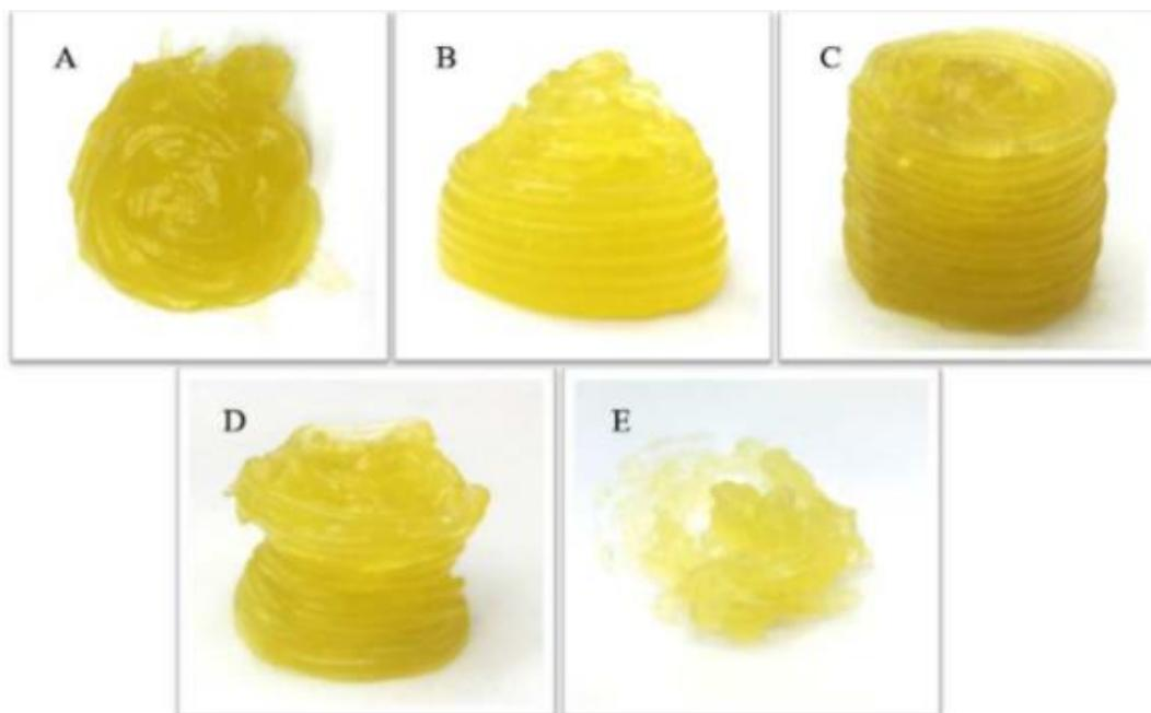
**Slika 2.** Isprintani sok od limuna s različitim dodatcima krumpirova škroba (A=10 g 100 g<sup>-1</sup>, B=12.5 g 100 g<sup>-1</sup>, C=15 g 100 g<sup>-1</sup>, D=17.5 g 100 g<sup>-1</sup>, E=20 g 100 g<sup>-1</sup>) (Yang i sur., 2018a).
