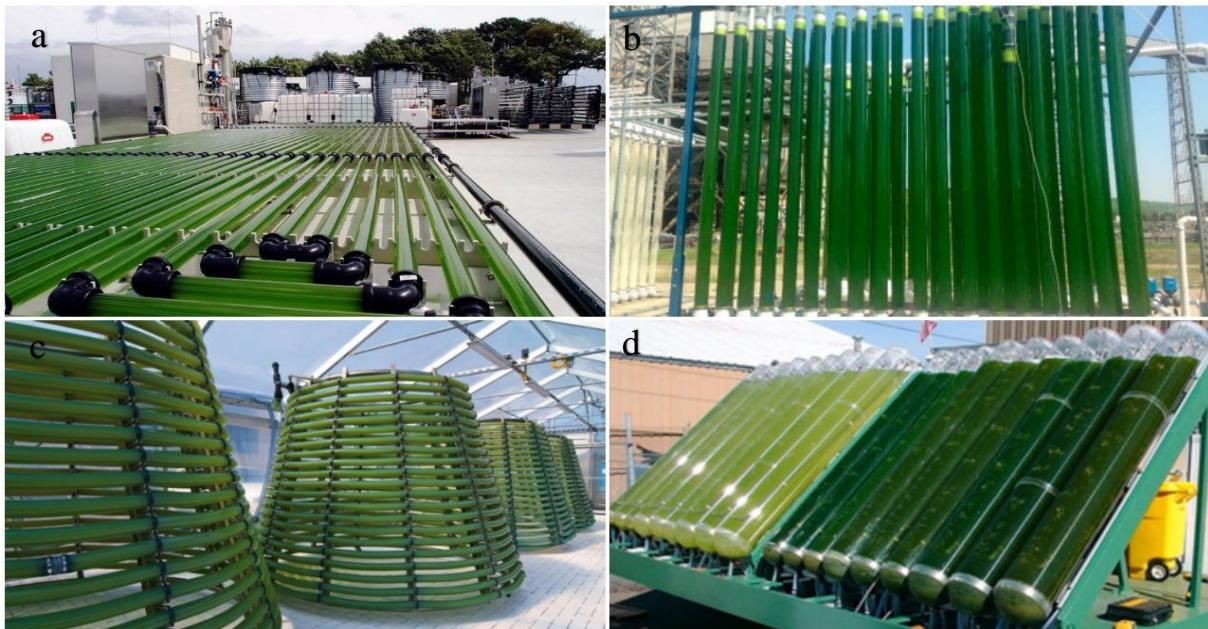
**Slika 3.** Prikaz cijevnih bioreaktora za uzgoj mikroalgi (a) horizontalni fotobioreaktor (De Vree i sur., 2015) (b) vertikalni fotobioreaktor (Mohler i sur., 2019) (c) spiralni fotobioreaktor (Koller, 2015) (d) koso postavljene barbotirajuće kolone (Bitog i sur., 2011).
