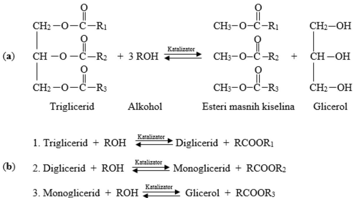
**Slika 7.** Transesterifikacija (a) Opća jednadžba (b) Reakcija u tri koraka (preuzeto i prilagođeno iz rada Fukuda i sur., 2001).
