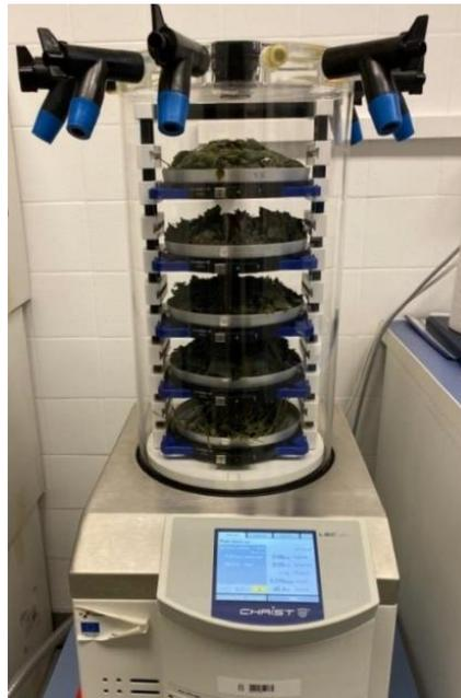
**Slika 7.** Liofilizacija uzoraka koprive (vlastita fotografija, 2019)
