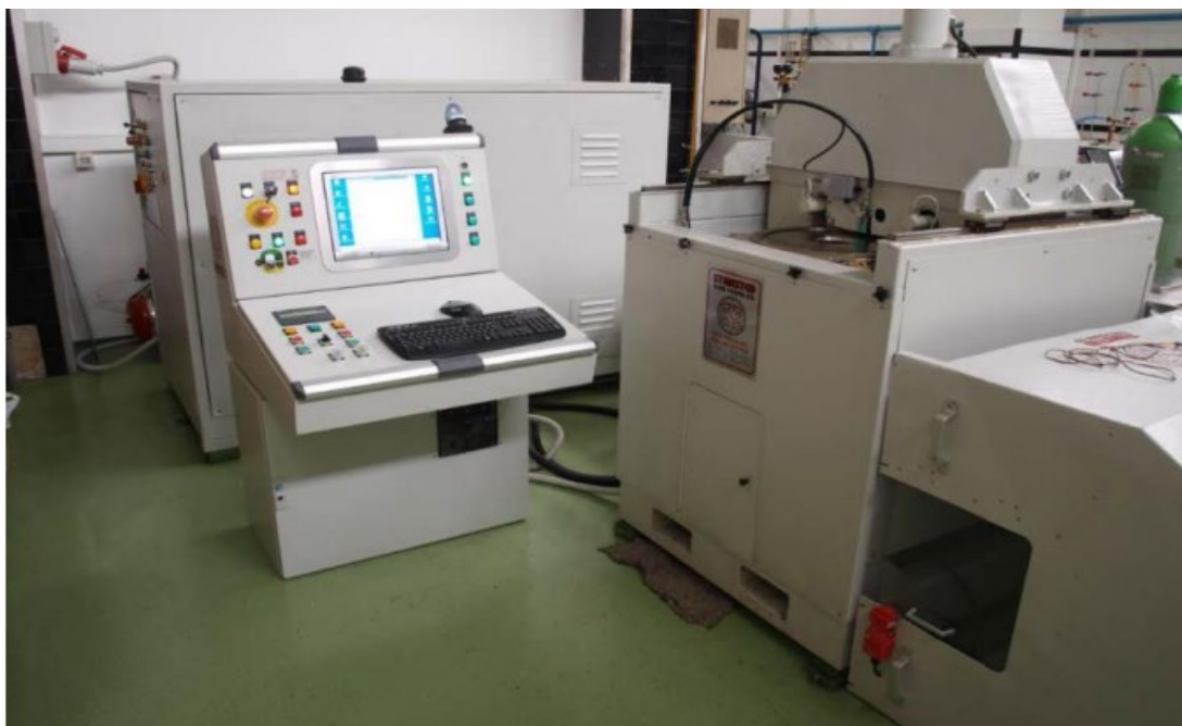
Slika 8. „Stansted Fluid Power“ Velika Britanija, uređaj za obradu visokim hidrostatskim tlakom*
