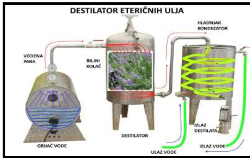
Slika 10. Shematski prikaz principa destilacije ljekovitog bilja u destilatoru (Anonymous 1, 2013)
