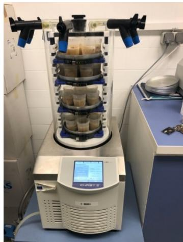
Slika 8. Proces liofilizacije (vlastita fotografija)
