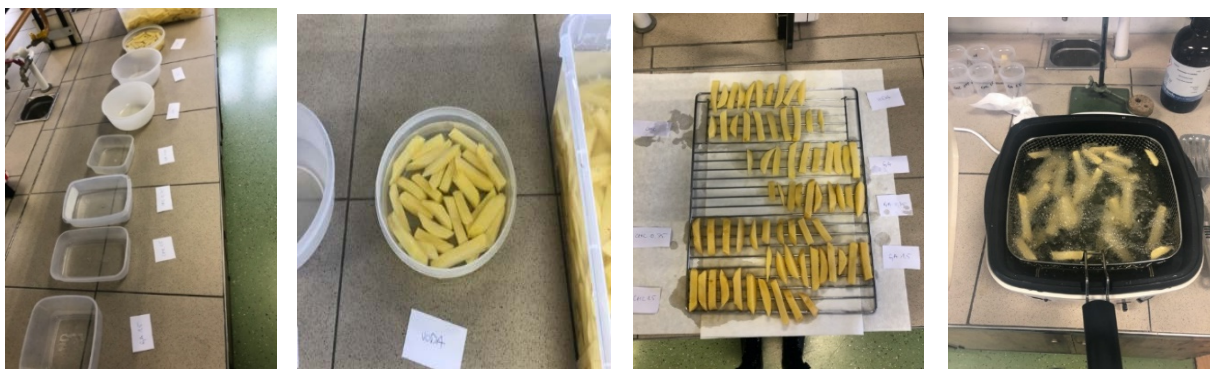
Slika 10. Postupak pripreme krumpira za analizu (s lijeva na desno: pripremljene formulacije premaza, namakanje krumpira u vodi (kontrolna grupa), sušenje krumpira nakon namakanja, prženje krumpira) (vlastita fotografija)
