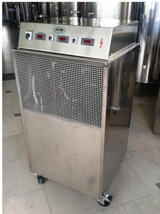
**Slika 26.** Mobilni rashladni uređaj (Pa-vin, 2016)
