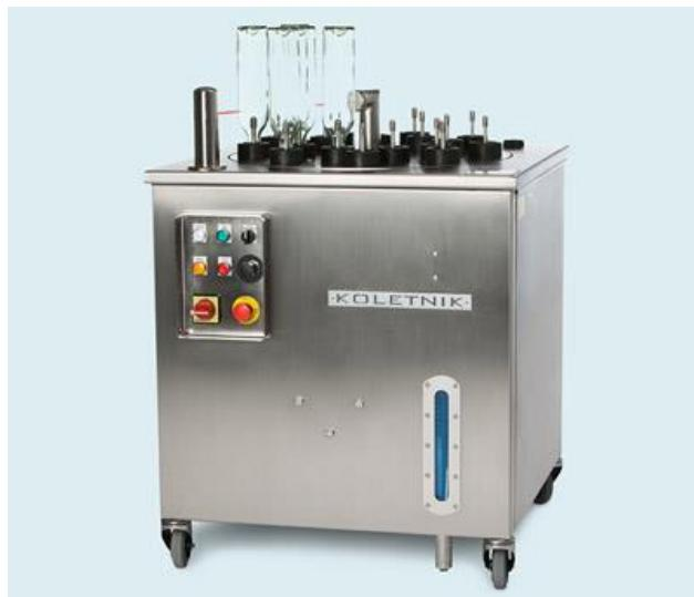
**Slika 32.** Uređaj za pranje i steriliziranje boca (Pa-vin, 2016)
