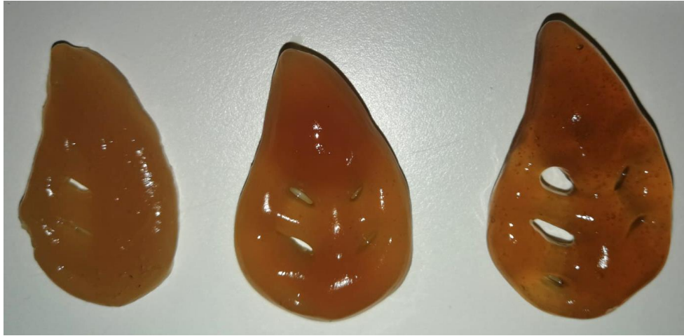
Slika 27. Razlike između 3D printanih alginatnih gelova s ekstraktom lista masline s obzirom na promjenu koncentracije alginata. (s lijeva na desno: uzorak 12 (3/0,8/150/150), 76 (4/0,8/150/150), 8 (5/08/150/150))
