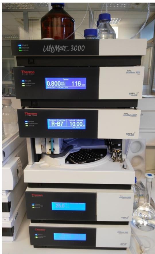
**Slika 4.** Visokodjelotvorni tekućinski kromatograf (HPLC) ThermoUltimate 3000 (vlastita fotografija).
