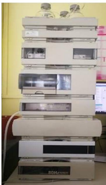
Slika 7. Tekućinski kromatograf s fluorescencijskim detektorom Agilent 1100 (NZJZ dr. Andrija Štampar)
