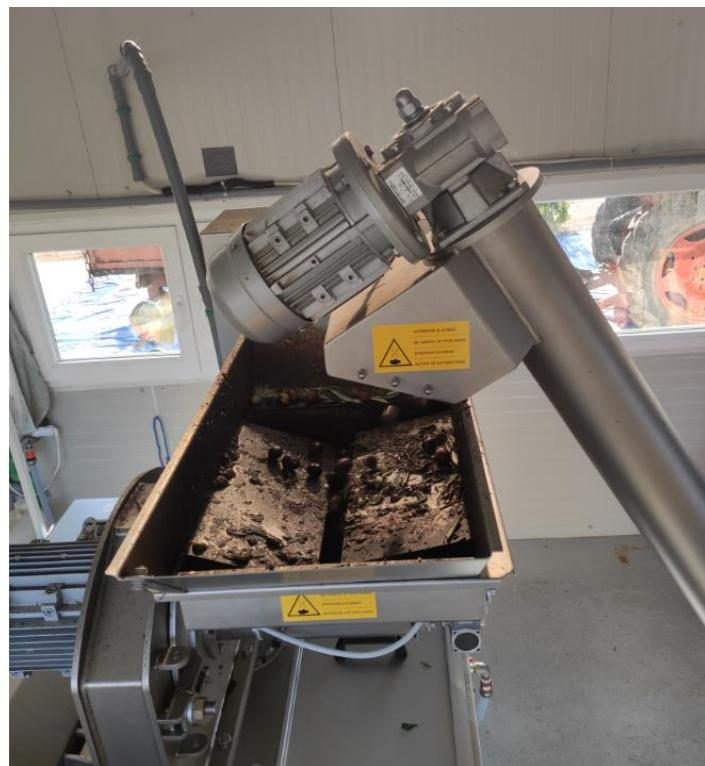
Slika 15 – Transport očišćenih maslina pomoću elevatora u sklopu Oliomio 200 Profy stroja
