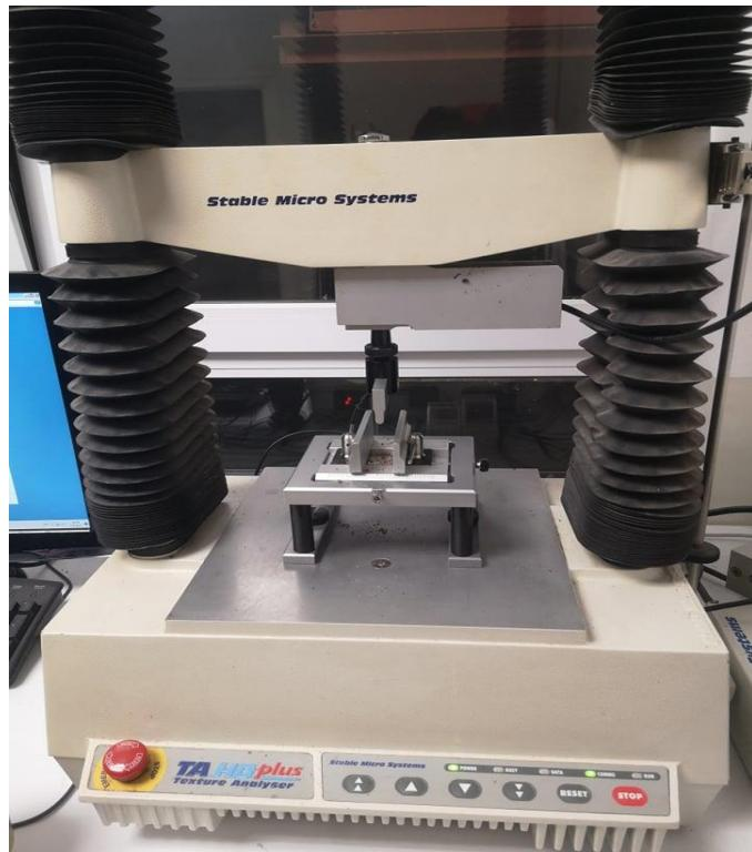
Slika 3. Teksturometar TA.HD.plus, Stable Micro Systems, UK (vlastita fotografija)
