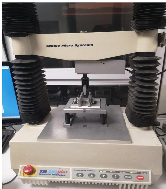
Slika 3. Teksturometar TA.HD.plus, Stable Micro Systems, UK (vlastita fotografija)
