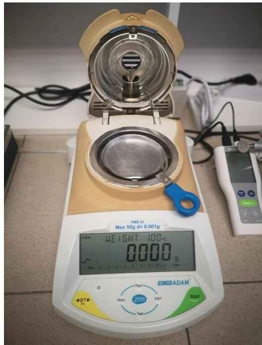
Slika 5. Analizator vlage PMB53 Adam Equipment (vlastita fotografija)
