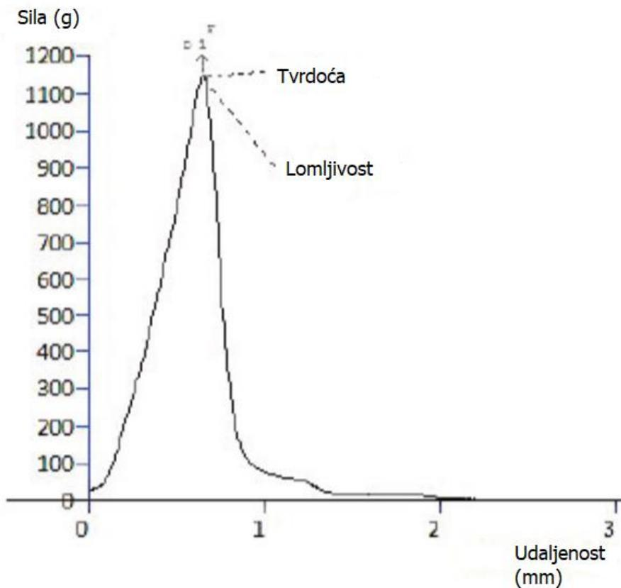
Slika 4. Tipična krivulja dobivena korištenjem HDP/3PB gdje vrh pika označava tvrdoću, a udaljenost oštice u trenutku pucanja lomljivost (Stable Micro Systems, pristupljeno 28. lipnja 2021.)
