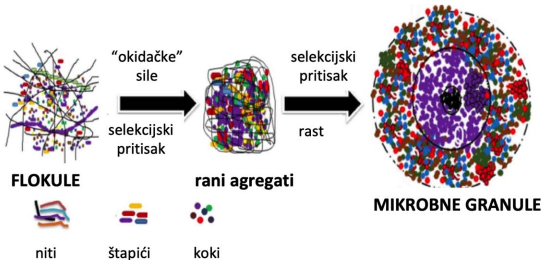
Slika 5. Mehanizam stvaranja AGS-a u SBR-u (Preuzeto i porilagođeno iz Nanchariah i Reddy, 2018)
