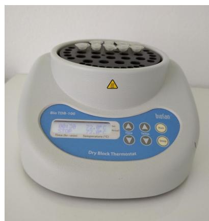
**Slika 11.** Termostatiranje uzorka za qRT-PCR pomoću Dry block thermostat Bio TDB-100 (BioSan, Riga, Latvija) [vlastita fotografija].
