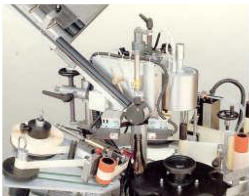
Slika 11: Čepilica i kapsulirka (www.pakiranje.hr)
