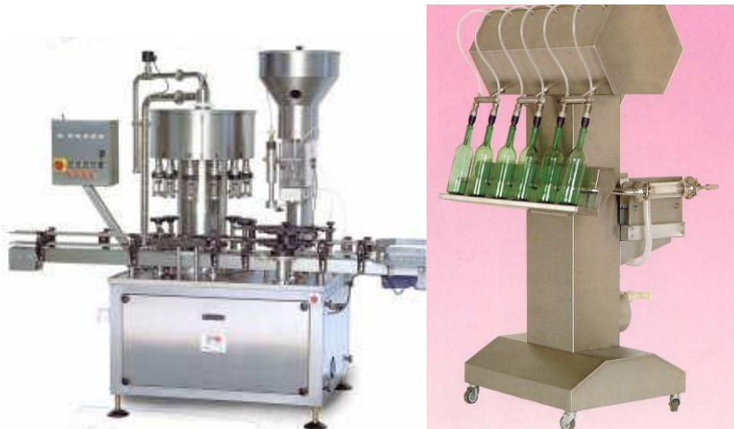
Slika 8: Automatska i poluautomatska punilica ( www.pakiranje.hr )
