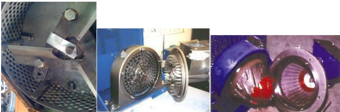
Slika 8. Metalni mlinovi; čekićar (Drljepan, 2014), s diskovima, konusni (Koprivnjak, 2006)
