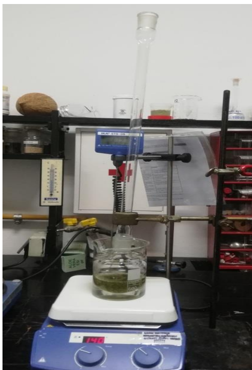
Slika 10. Ekstrakcija etanolom uz zračno hladilo
