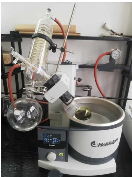
Slika 12. Uparavanje ekstrakta na rotirajućem uparivaču
