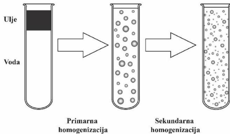
Slika 7. Shematski prikaz primarne i sekundarne homogenizacije (McClements, 2015)
