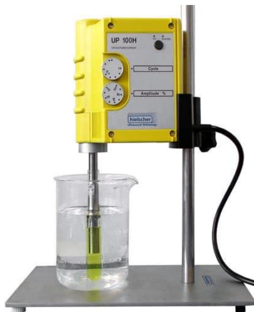
Slika 11. Ultrazvuk visokog intenziteta „ dr. Hielscher UP 100H “, Njemačka (Hielscher, 2020)
