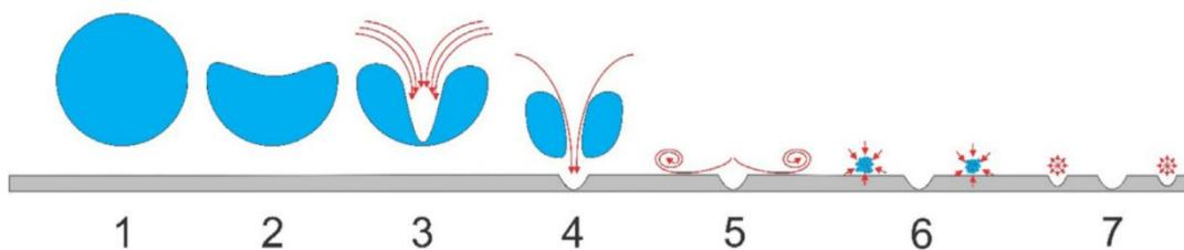
Slika 3. Shematski prikaz implozije mjeđurića (Zupanc i sur., 2019)
