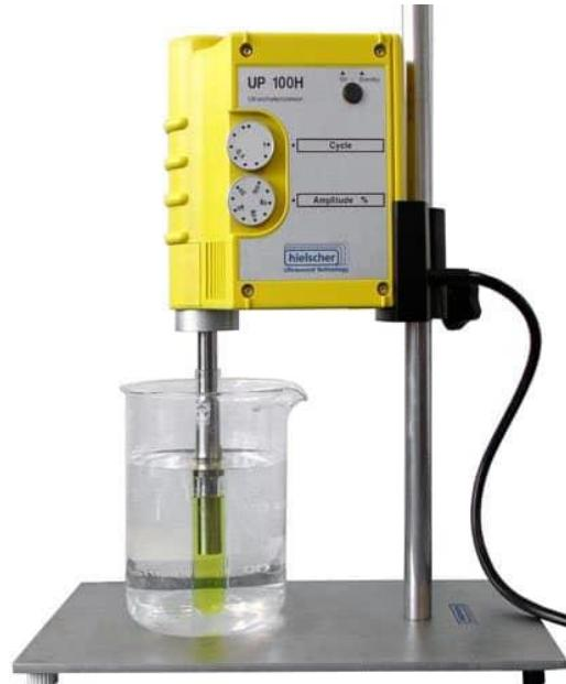
Slika 11. Ultrazvuk visokog intenziteta „dr. Hielscher UP 100H“,
