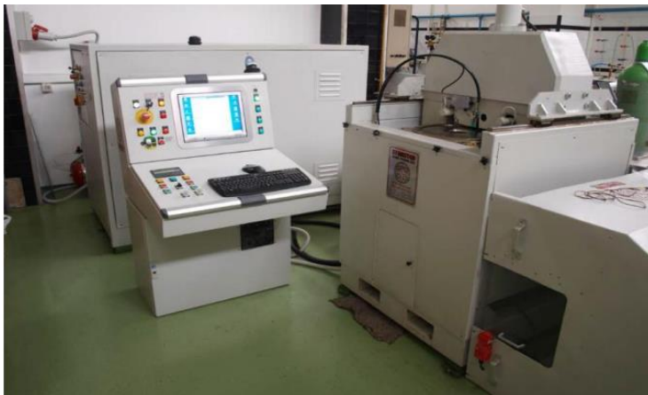
Slika 12. „ Stansted Fluid Power “ Velika Britanija, uređaj za obradu visokim hidrostatskim tlakom (vlastita fotografija)
