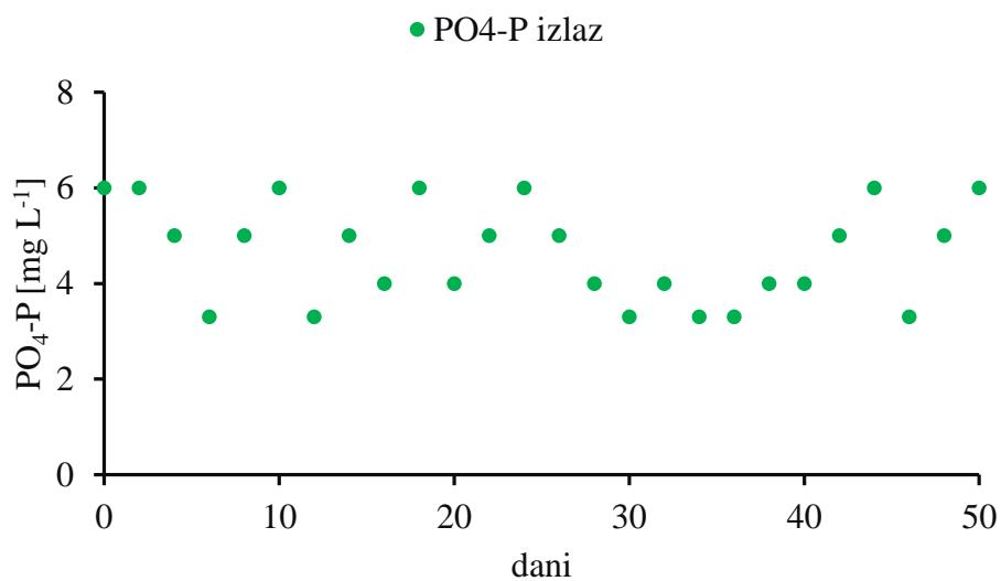
Slika 21. Koncentracija  $\text{PO}_4\text{-P}$  u izlazu pri omjeru KPK/N 5 i koncentraciji otopljenog kisika  $1\text{-}2 \text{ mg DO L}^{-1}$
