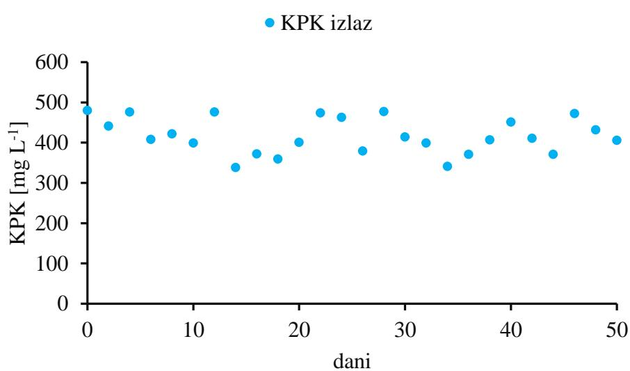
Slika 11. Koncentracija KPK u izlazu pri omjeru KPK/N 11,5 i koncentraciji otopljenog kisika 0-1 mg DO L<sup>-1</sup>
