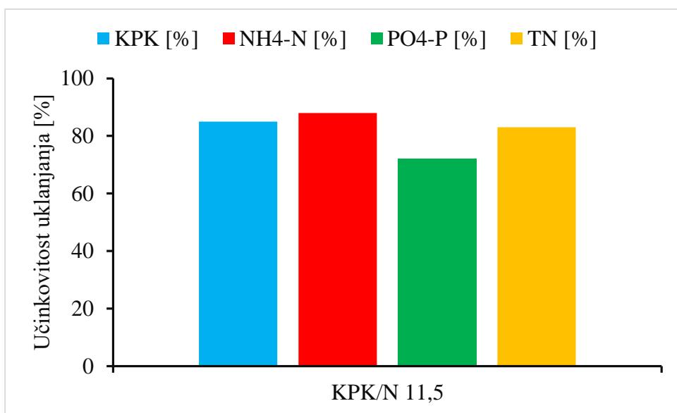
Slika 14. Učinkovitost uklanjanja KPK, NH<sub>4</sub>-N, PO<sub>4</sub>-P i ukupnog dušika pri omjeru KPK/N 11,5 i koncentraciji otopljenog kisika 1-2 mg DO L<sup>-1</sup>
