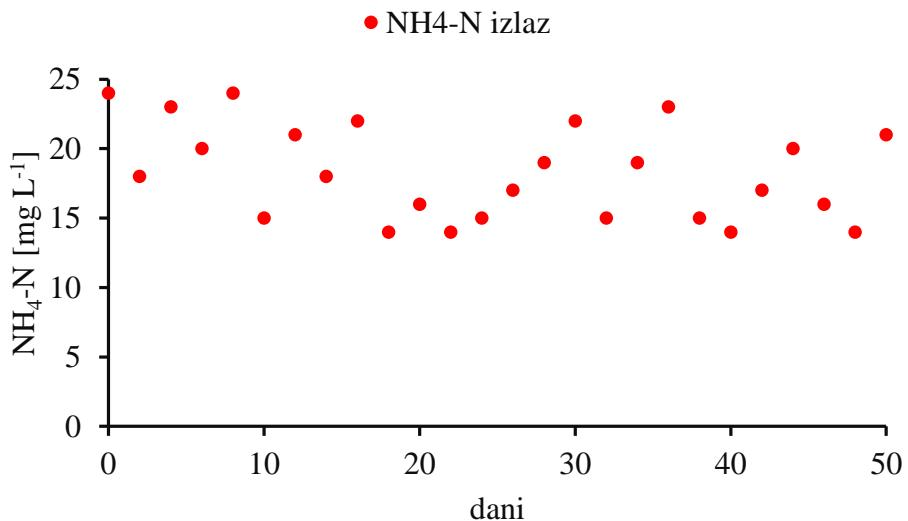
Slika 20. Koncentracija  $\text{NH}_4\text{-N}$  u izlazu pri omjeru KPK/N 5 i koncentraciji otopljenog kisika  $1\text{-}2 \text{ mg DO L}^{-1}$
