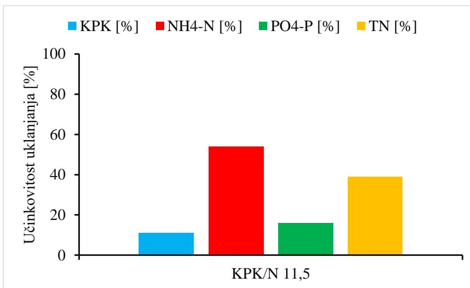
Slika 10. Učinkovitost uklanjanja KPK, NH<sub>4</sub>-N, PO<sub>4</sub>-P i ukupnog dušika pri omjeru KPK/N 11,5 i koncentraciji otopljenog kisika 0-1 mg DO L<sup>-1</sup>
