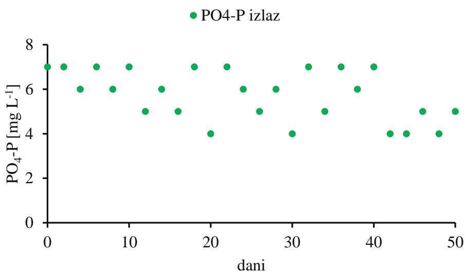
Slika 13. Koncentracija  $\text{PO}_4\text{-P}$  u izlazu pri omjeru KPK/N 11,5 i koncentraciji otopljenog kisika  $0\text{-}1 \text{ mg DO L}^{-1}$
