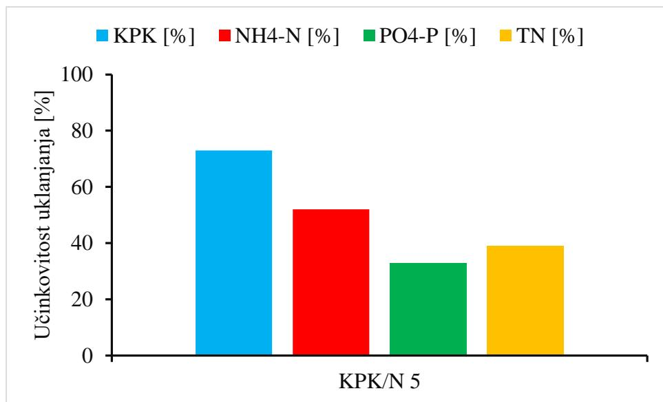
Slika 18. Učinkovitost uklanjanja KPK, NH<sub>4</sub>-N, PO<sub>4</sub>-P i ukupnog dušika pri omjeru KPK/N 5 i koncentraciji otopljenog kisika 1-2 mg DO L<sup>-1</sup>
