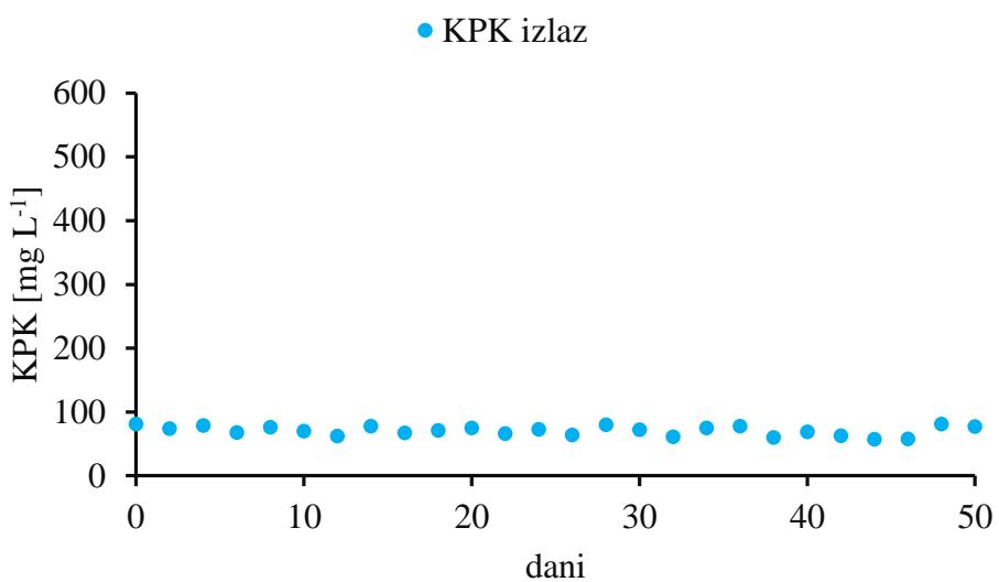
Slika 15. Koncentracija KPK u izlazu pri omjeru KPK/N 11,5 i koncentraciji otopljenog kisika 1-2 mg DO L<sup>-1</sup>
