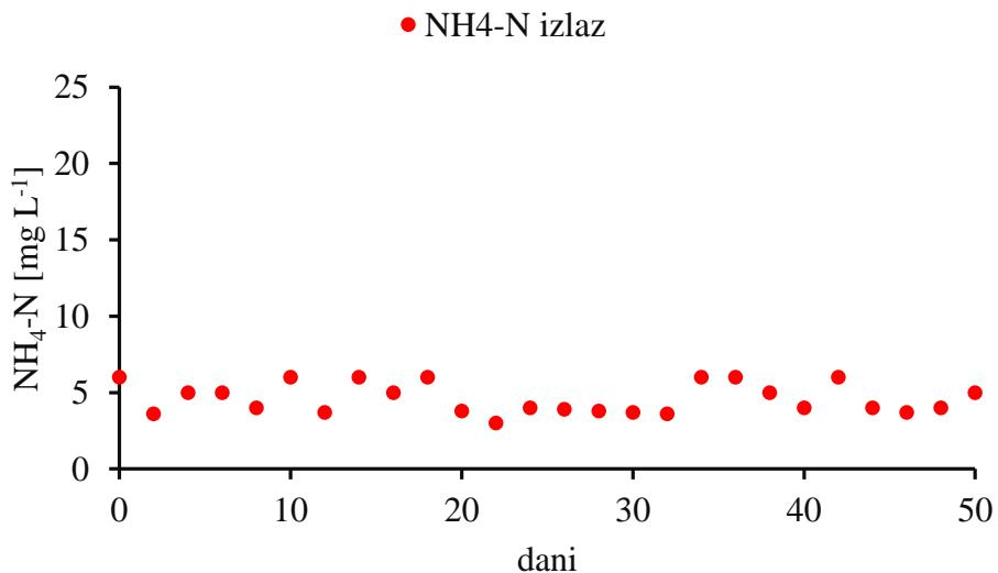
Slika 16. Koncentracija NH<sub>4</sub>-N u izlazu pri omjeru KPK/N 11,5 i koncentraciji otopljenog kisika 1-2 mg DO L<sup>-1</sup>
