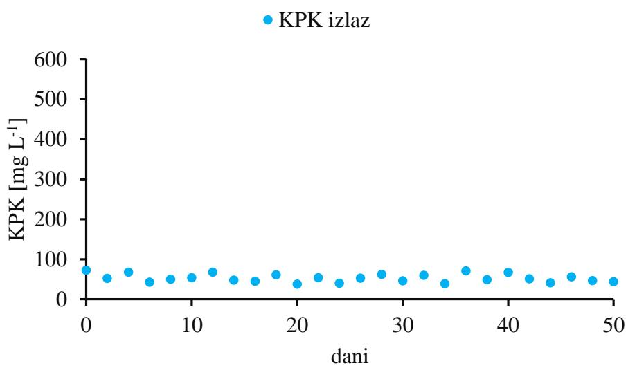
Slika 19. Koncentracija KPK u izlazu pri omjeru KPK/N 5 i koncentraciji otopljenog kisika 1-2 mg DO L<sup>-1</sup>
