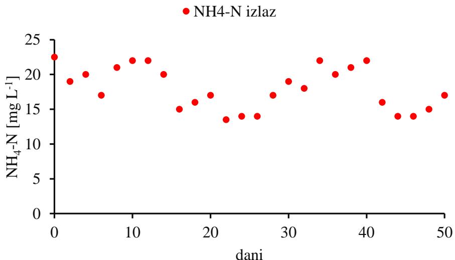
Slika 12. Koncentracija  $\text{NH}_4\text{-N}$  u izlazu pri omjeru KPK/N 11,5 i koncentraciji otopljenog kisika  $0\text{-}1 \text{ mg DO L}^{-1}$
