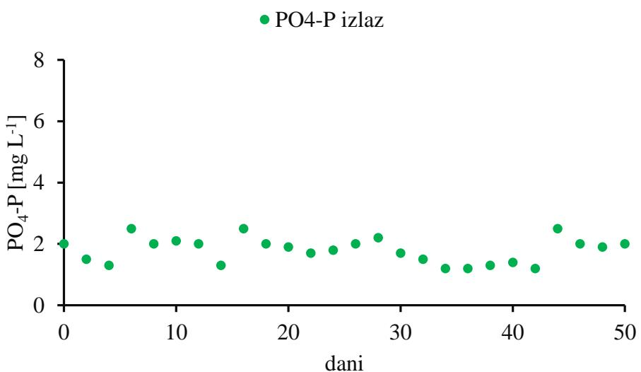
Slika 17. Koncentracija PO<sub>4</sub>-P u izlazu pri omjeru KPK/N 11,5 i koncentraciji otopljenog kisika 1-2 mg DO L<sup>-1</sup>
