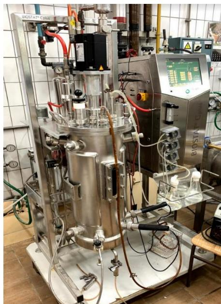
**Slika 8.** Bioreaktor s miješalom Biostat Cplus (vlastita fotografija)
