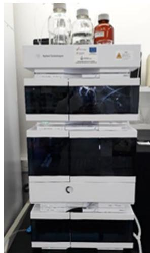
**Slika 9.** Uredaj za tekućinsku kromatografiju ultravisoke djelotvornosti (UPLC) (vlastita fotografija)
