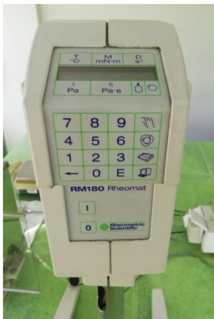
Slika 8. Rotacijski reometar za mjerenje viskoznosti: sučelje (vlastita fotografija)
