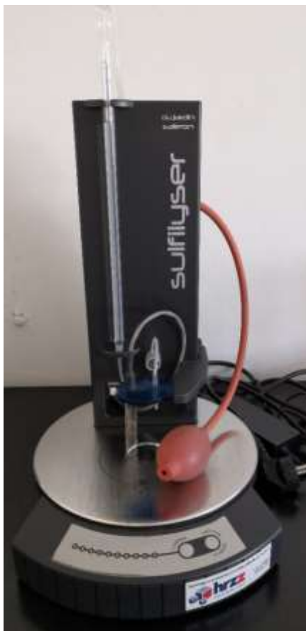
Slika 10. Uređaj za određivanje slobodnog i ukupnog sumporovog dioksida u vinu (vlastiti izvor)
