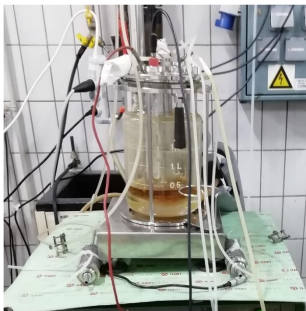
Slika 5. Bioreaktor s miješalom (B. Braun Biotech International, Berlin, Njemačka) (vlastita fotografija)
