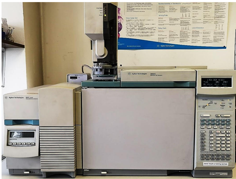
Slika 6. Plinski kromatograf Agilent Technologies 6890N Network GC System s masenim detektorom tipa 5973 inert Mass Selective Detector (vlastita fotografija)
