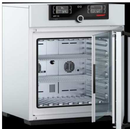
Slika 7. Ventilirana klima komora (Anonymous 5, Memmert, Njemačka)
