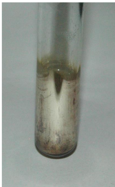
Slika 6. 11. Nastanak srebrnog zrcala (Tollensova reakcija). Izvor: autori.
