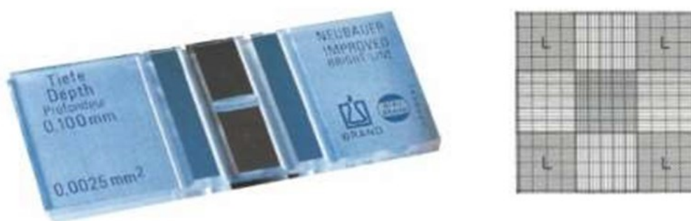
Slika 8. Prikaz Neubauerove komorice (lijevo) i kvadrata za brojanje stanica (desno) (Anonymous, 2021)
