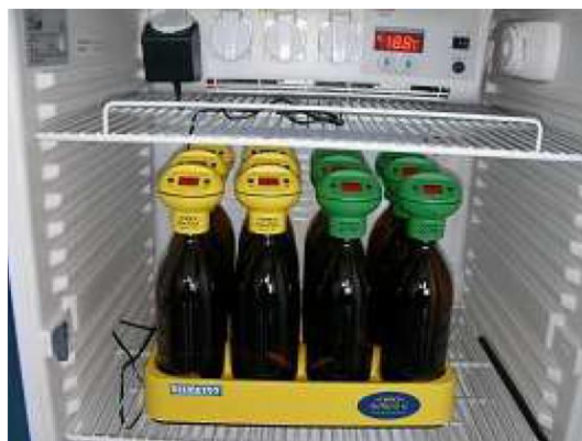
Slika 9. Set od 12 OxiTop boca s pripadajućim senzorima, elektromagnetskom miješalicom i termostatom radi osiguravanja konstantne temperature tijekom određivanja (Perić, 2012)
