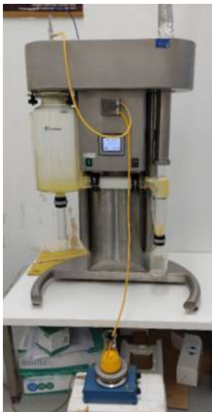
Slika 7. Uređaj za sušenje raspršivanjem (vlastita fotografija)
