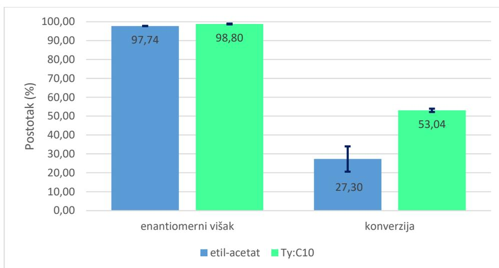
**Slika 12.** Grafički prikaz rezultata konverzije i enantiomernog viška za niskotemperaturno eutektičko otapalo Ty:C<sub>10</sub> i za organsko otapalo etil-acetat
