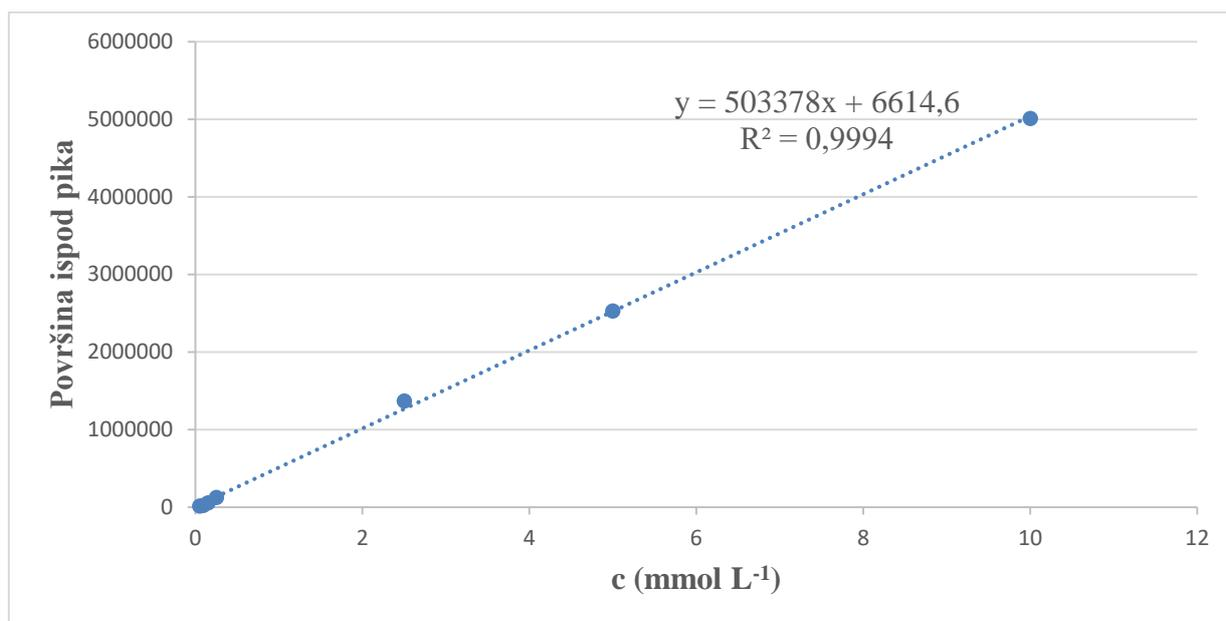
**Slika 7.** Baždarni dijagram za određivanje koncentracije (*S*)-1-feniletil-acetata
