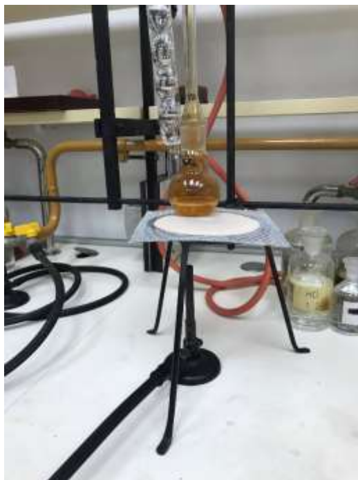
Slika 9. Određivanje udjela celuloze Kürschnerovim i Hanakovim postupkom, zagrijavanje tikvice s povratnim zračnim hladilom (vlastita fotografija)
