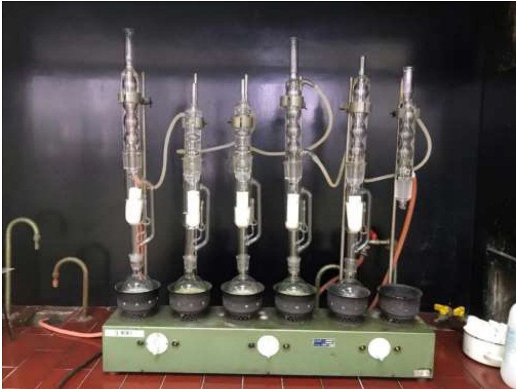
Slika 8. Određivanje udjela masti metodom po Soxhletu, postupak ekstrakcije (vlastita fotografija)
