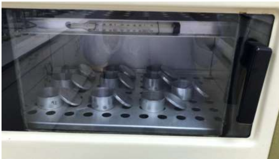
Slika 6. Sušenje uzorka u zračnoj sušnici (vlastita fotografija)
