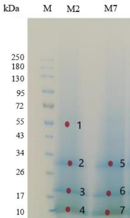
**Slika 21.** SDS-PAGE gel uzorka M2 i M7. M-standardi.
