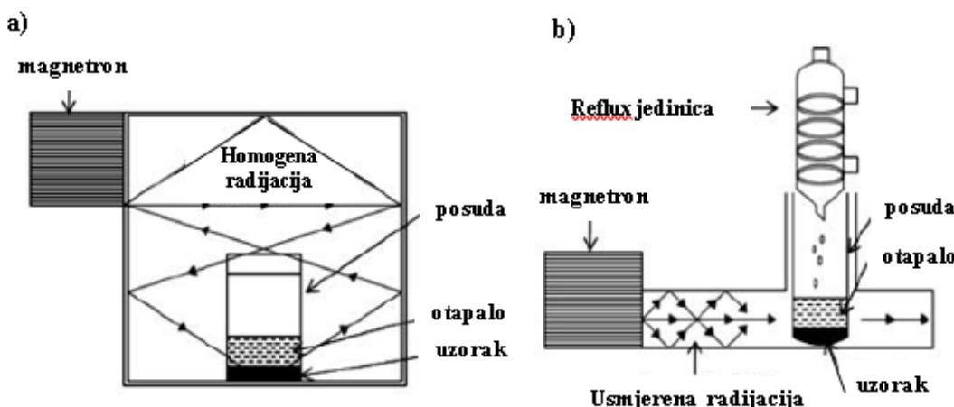
**Slika 7.** Zatvoreni mikrovalni sustav (a) i otvoreni mikrovalni sustav (b) (Mandal i sur., 2007)
