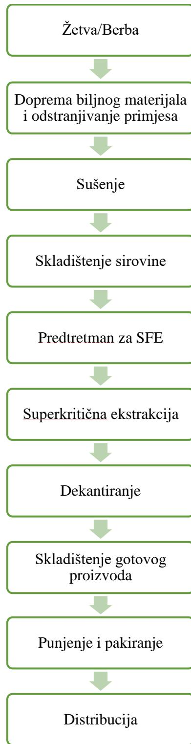
**Slika 9.** Blok-shema tehnološkog procesa za dobivanje superkritičnih ekstrakata iz sjemenki komorača, plodova mirte te plodova pasjeg trna (vlastita shema)
