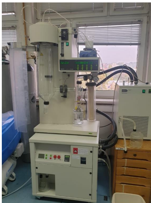
Slika 6. Mini Spray Dryer B-290 (vlastita fotografija)
