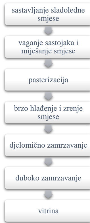
Slika 3. Dijagram tijeka proizvodnje zanatskog sladoleda (Anonymus 2)
