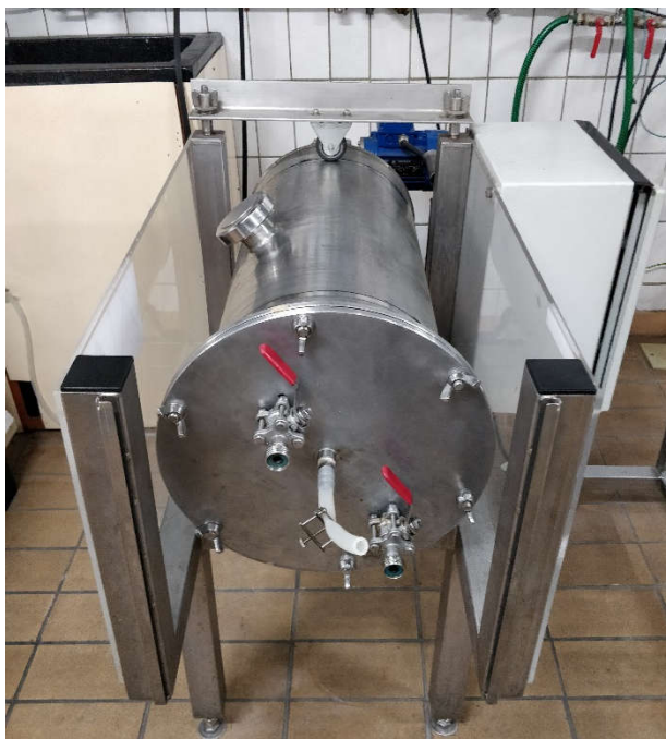
Slika 7. Horizontalni rotirajući cijevni bioreaktor (HRCB).
