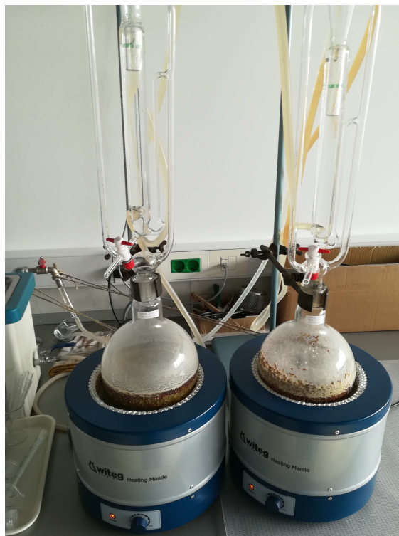
Slika 22. Clevenger hidrodestilacija (vlastita fotografija).
