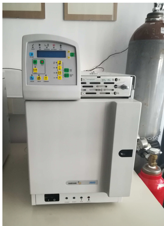
Slika 35. GC-FID uređaj (vlastita fotografija).
