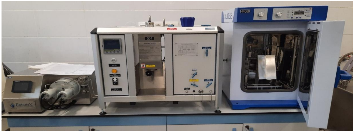
Slika 1. Uređaj za ekstrakciju superkritičnim CO 2
