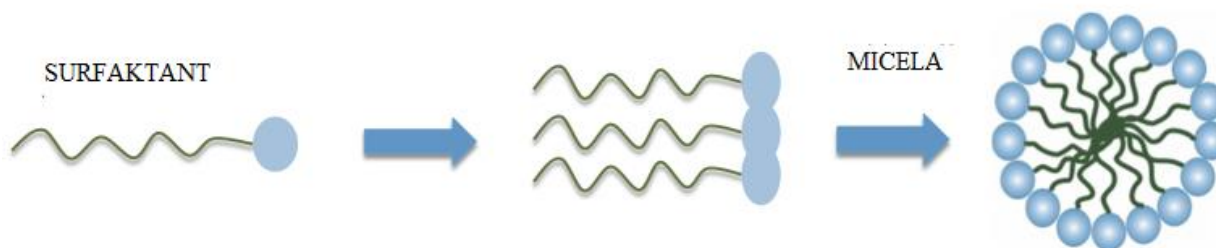
Slika 3. Formiranje micela (Block Copolymer Nanoparticles, 2022)
