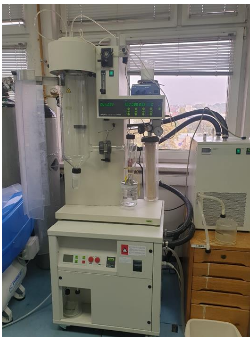
Slika 3. Sušionik s raspršivanjem Büchi Mini Spray Dryer B-290 (vlastita fotografija)
