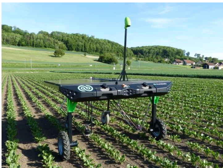
Slika 11. Autonomni robot za uklanjanje korova (Anonymous 6)
