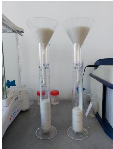
**Slika 5.** Određivanje stabilnosti pjene metodom prve i zadnje kapi (vlastita fotografija)
