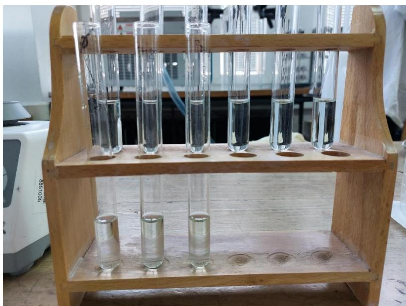
**Slika 7.** Epruvete sa uzorcima proteina različitih koncentracija i pH vrijednosti
