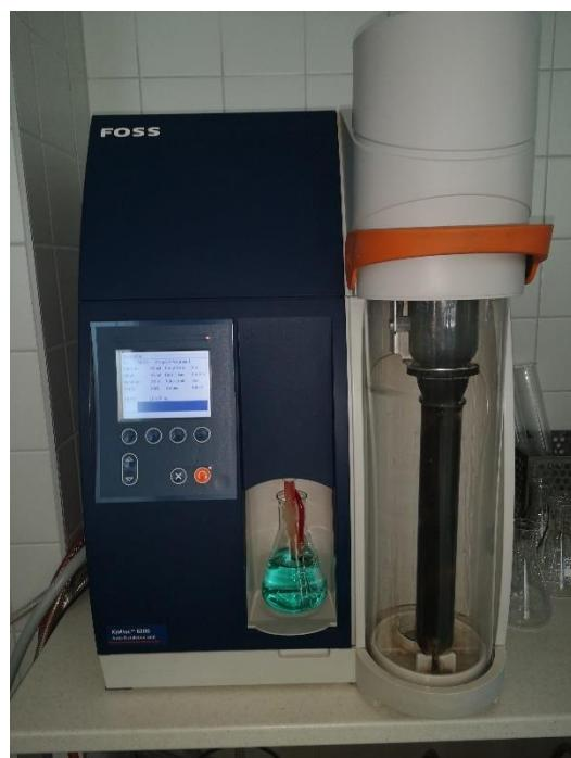
**Slika 6.** Destilacijska jedinica Kjeltec sustava, Kjeltec 8200 (vlastita fotografija).
