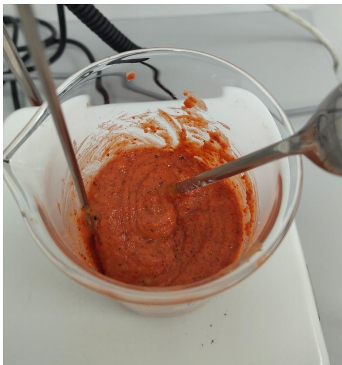
Slika 5. Zagrijavanje smjese za 3D ispis na magnetskoj miješalici s grijanjem (Vlastita fotografija)
