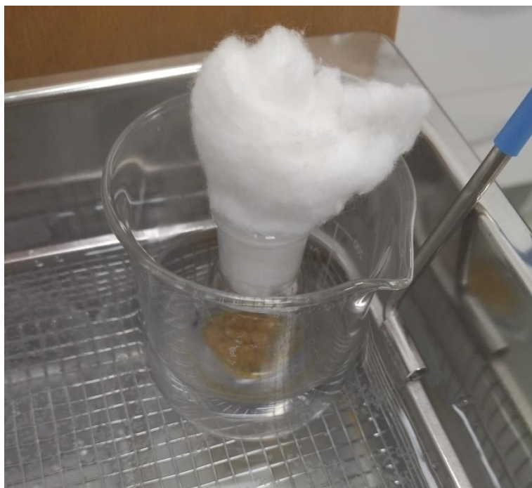
Slika 10. Ekstrakcija u ultrazvučnoj kupelji (Vlastita fotografija)
