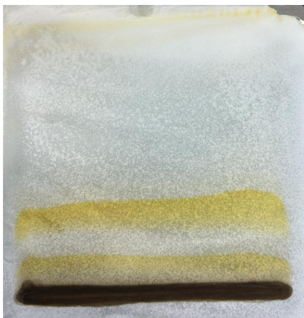
Slika 10. Pročišćavanje produkta tanskoslojnom preparativnom kromatografijom na silikagelu (vlastita fotografija)
