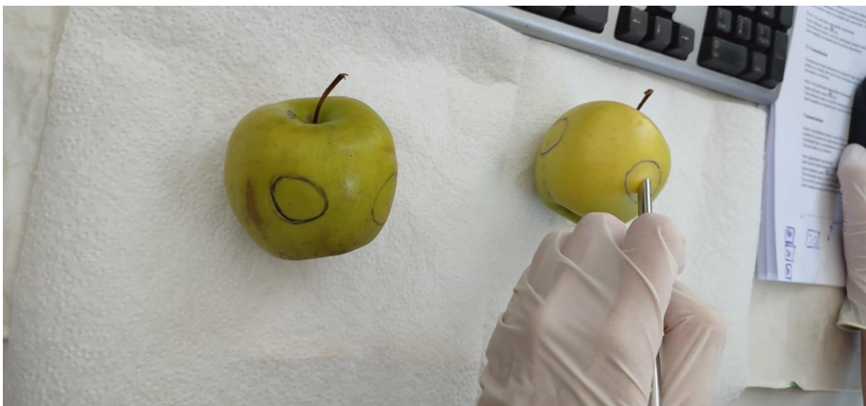
Slika 3. Prikaz snimanja netretiranih i tretiranih jabuka NIR sondom ( vlastita fotografija )
