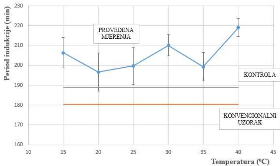
**Slika 7.** Oksidacijska stabilnost DMU iz sorte istarska bjelica proizvedenog bez i uz UTT
